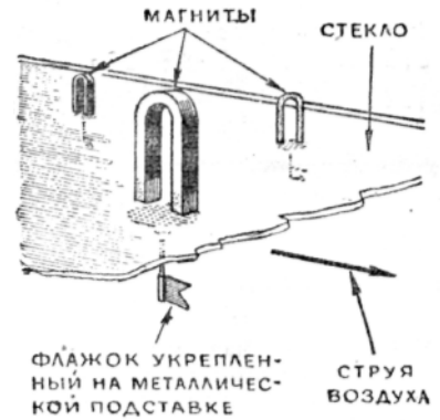
Для наблюдения движения потока на воздушной модели используются флажки, передвигаемые при помощи магнита.
